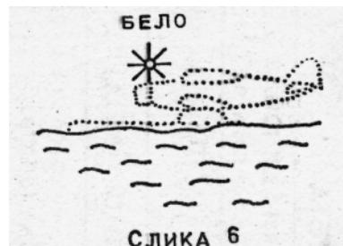
Ako je dužina privezanog hidroaviona manja od 50 metara (150 st), istaknuće se na najpogodnijem mestu stalno belo svetlo vidljivo sa svih strana sa udaljenosti od najmanje 2 NM (slika 6).
