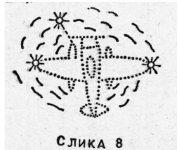
Ako je raspon krila hidroaviona 50 metara (150 st) ili veći, istaknuće se sa svake strane krila po jedno stalno belo svetlo da bi se označio maksimalni raspon krila. Ta svetla treba da budu vidljiva sa svih strana sa udaljenosti od najmanje 1 NM (slika 8).
